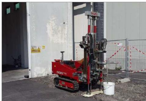
Esecuzione dell'indagine penetrometrica dinamica superpesante D.P.S.H.
